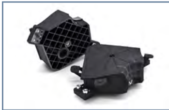
Nachbearbeitet Konturaufnahme (schwarz gefärbt mit Justierungen und Metallgewinden)
